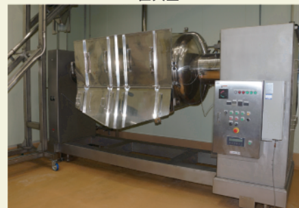
ジャケット付ニーダー釜
